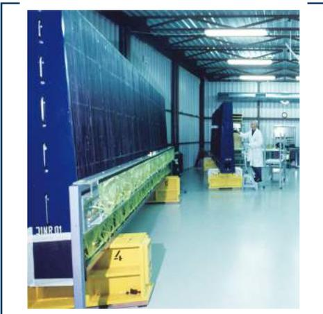
O LIP teve um papel central no desenvolvimento da óptica do calorímetro TileCal de ATLAS: projeto, otimização dos cintiladores e fibras ópticas em colaboração com os fabricantes, desenho do sistema de inserção e condução das fibras. O LIP fez a aluminização, teste e inserção semi-automática das 600 000 fibras ópticas do detetor. Os sinais luminosos gerados nos cintiladores pelos hadrões são conduzidos pelas fibras até aos sensores de luz.
