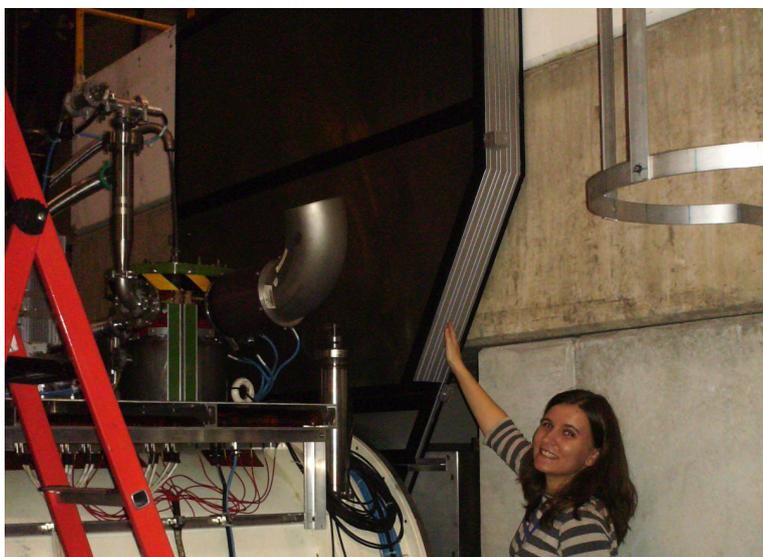
Márcia Quaresma (LIP), ao lado do alvo polarizado de COMPASS (cilindro branco), do novo detetor de vértices (com um suporte superior), e do novo absorvedor de hádrons (rodeado por blocos de cimento). A Márcia foi a responsável pelo alinhamento dos detetores da experiência.
