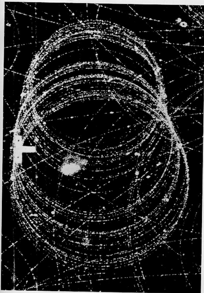
Um electrão com uma energia inicial de 16.9 MeV move-se em espiral num campo magnético, sendo visíveis 36 voltas.
