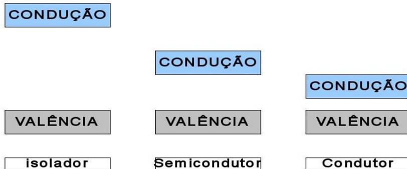
Figura 2.10 Esquema das bandas de valência de um semiconductor
