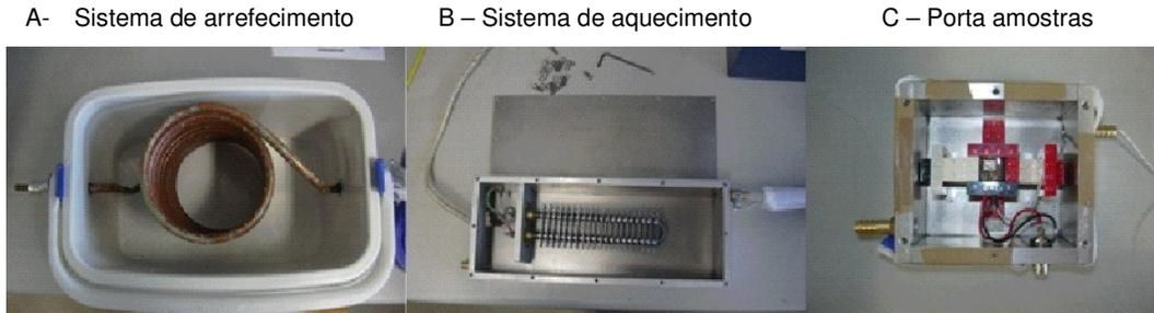
Figura 4.3 Equipamento construído para estudar a influência da temperatura na resposta dos fotodiodos
