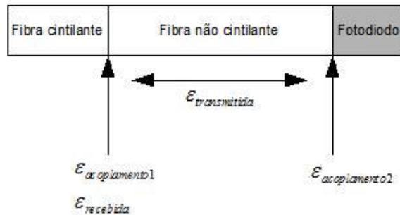
Figura 4.28 Esquema ilustrativo da ligação entre os diferentes componentes do sistema (adaptado de [BED03]).
