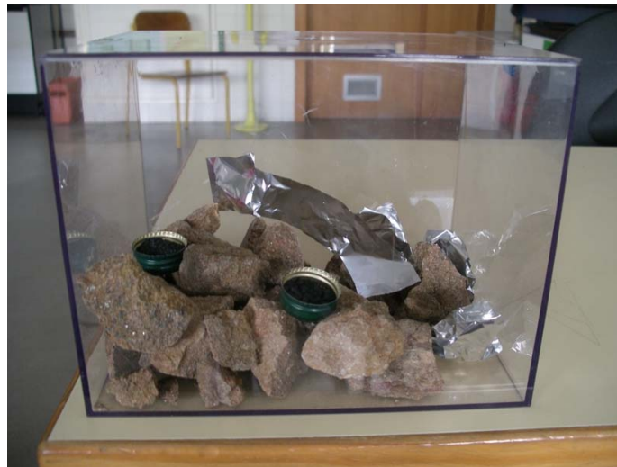
Figura 6.36: Gerador de radão.
