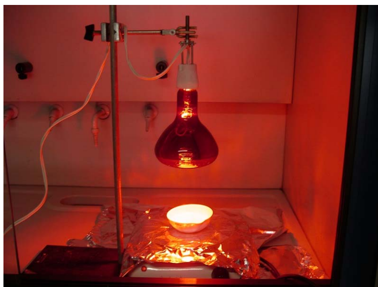
Figura 6.63: Evaporação da água até à secura numa cápsula de porcelana, realizada na hotte após adição de 1 mL de ácido sulfúrico.
