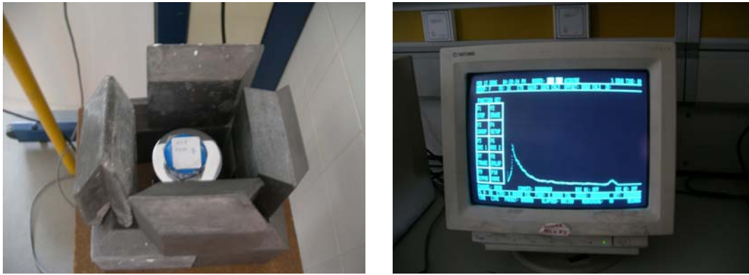
(a) (b) Figura 6.47: (a) Detector NaI(Tl) com a amostra de cloreto de potássio e (b) respectivo espectro com fundo.
