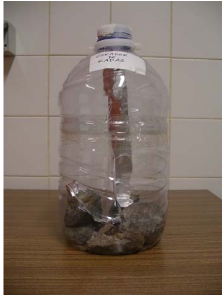
Figura 5.12: Gerador de radão.
