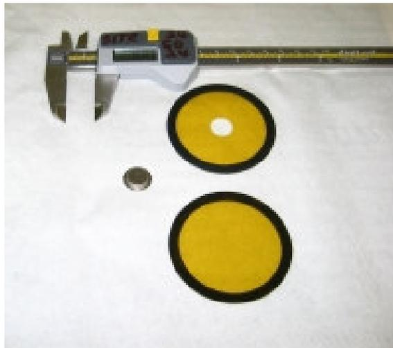
Figura 6.1 – Porta amostras de titânio e tamanho de uma amostra típica.
