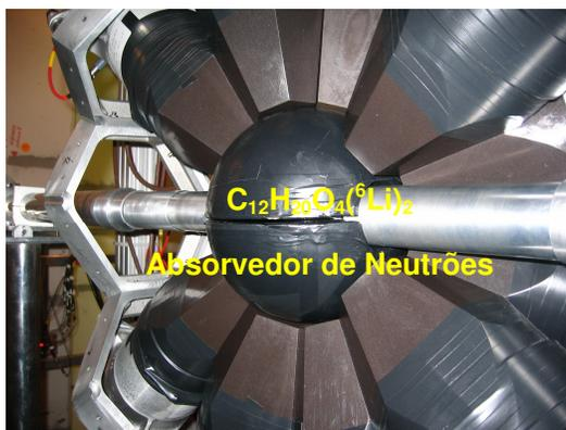
Fig. 4.6 – Absorvedor de  $^6\text{Li}$ ,  $\text{C}_{12}\text{H}_{20}\text{O}_4(^6\text{Li})_2$ , em torno da amostra com o intuito de minimizar o número de neutrões dispersos na amostra e outros constituintes das vizinhanças que são detectados no TAC.
