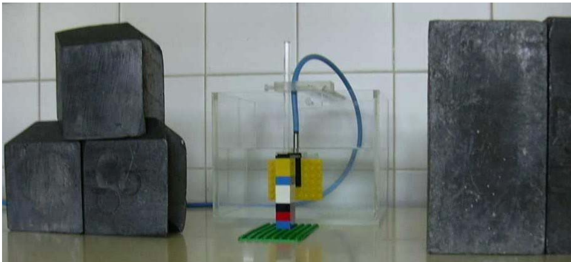
Fotografia 4.4. Fantoma de água, com a montagem da câmara de ionização, a fonte de ^{60}\text{Co} montada em peças de LEGO e dois castelos de chumbo para protecção.
