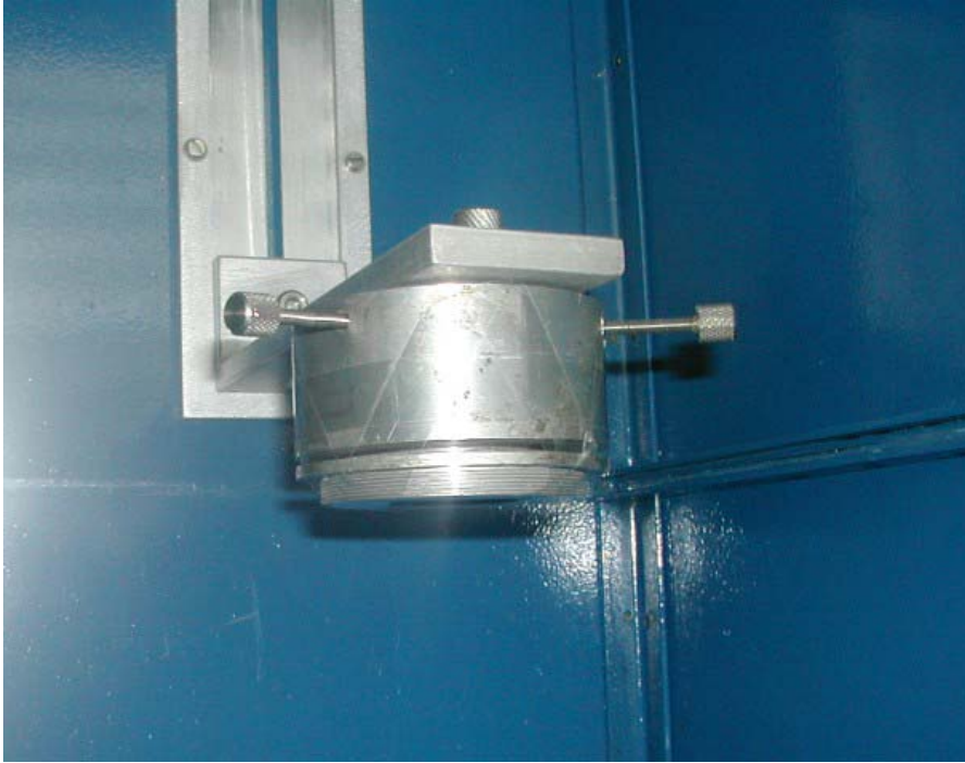
Fotografia 4.9. Fonte de ^{241}\text{Am} colocada dentro da caixa de chumbo azul
