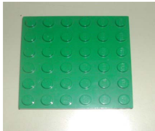
Fotografia 4.7. Peça de LEGO com as nove fontes de ^{60}\text{Co} encapsuladas
