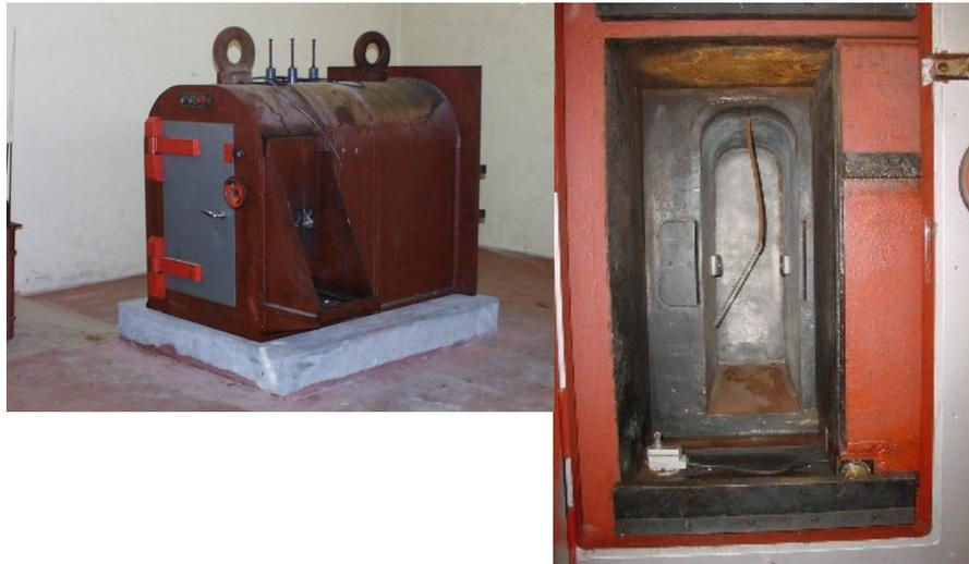
**Figura 24** – Câmara de irradiação da unidade experimental de  $^{60}\text{Co}$ , Precisa 22 ML.
