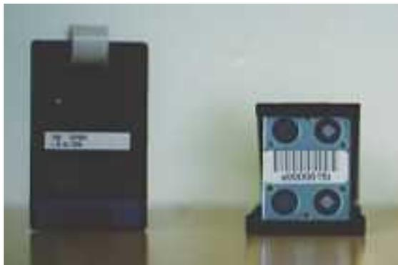
**Figura 27** – Dosímetro de corpo inteiro (Harshaw 8814). À esquerda: invólucro ou porta-dosímetro; direita: cartão contendo os dosímetros de TLD-100.
