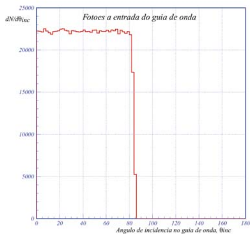
Fig.4. 4- Distribuição do ângulo de incidência dos fótons de Cherenkov na base do guia de onda. \theta\gamma .
