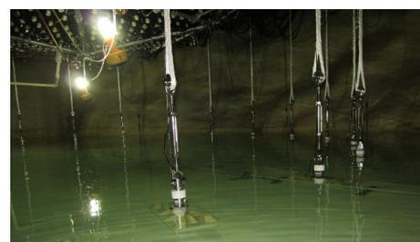
coisas, da instalação da primeira parte do "nosso" sistema de fibras, a caverna experimental de SNO+ está pronta a ser enchida de água. É ainda um enchimento provisório, para verificar a estanquicidade do revestimento da caverna, mas mesmo assim, é muito bom já ver na foto o fundo todo coberto com cerca de 0.5 m de água. Quando tiver mais uns 10 m em cima, será altura de ir andar de barco para instalar o resto das fibras...
