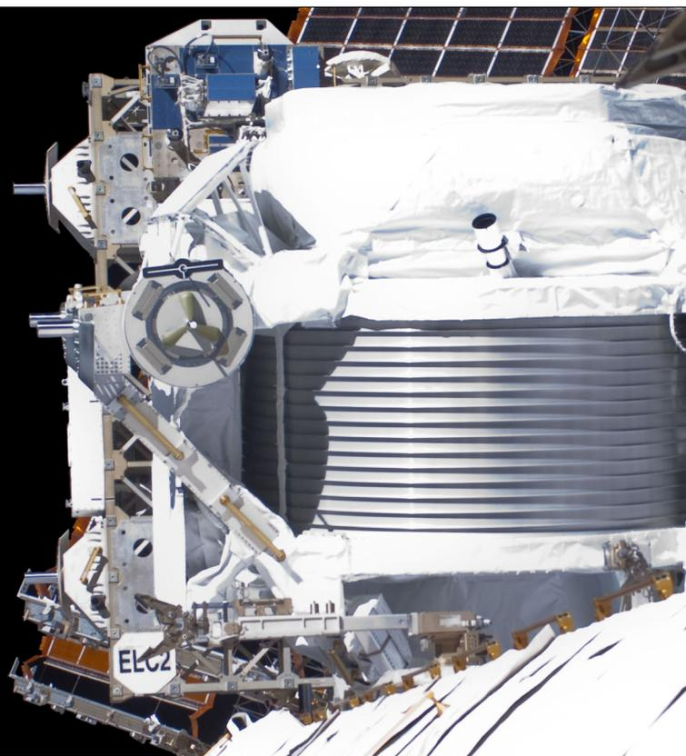
Figura: Em órbita na ISS a cerca de 400 km da Terra, O Espectrómetro Magnético Alpha (AMS) recolhe dados sobre os raios cósmicos primários que atravessam o detector.
