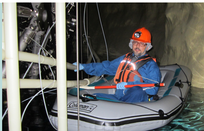
José Maneira (LIP) durante a instalação no detetor SNO+ do sistema de calibração dos sensores de luz com fibras ópticas.
